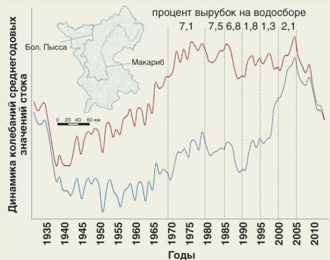
Рис. 3. Корреляция кривых стока по данным гидропостов Макариб (красная линия) и Большая Пысса (синяя линия) с долей лесозаготовок на водосборе
