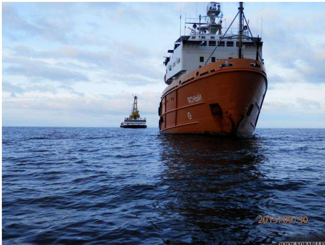
Рис. 3.2 Судно снабжения «Ясный» буксирует плавкран «СПК-43150»
