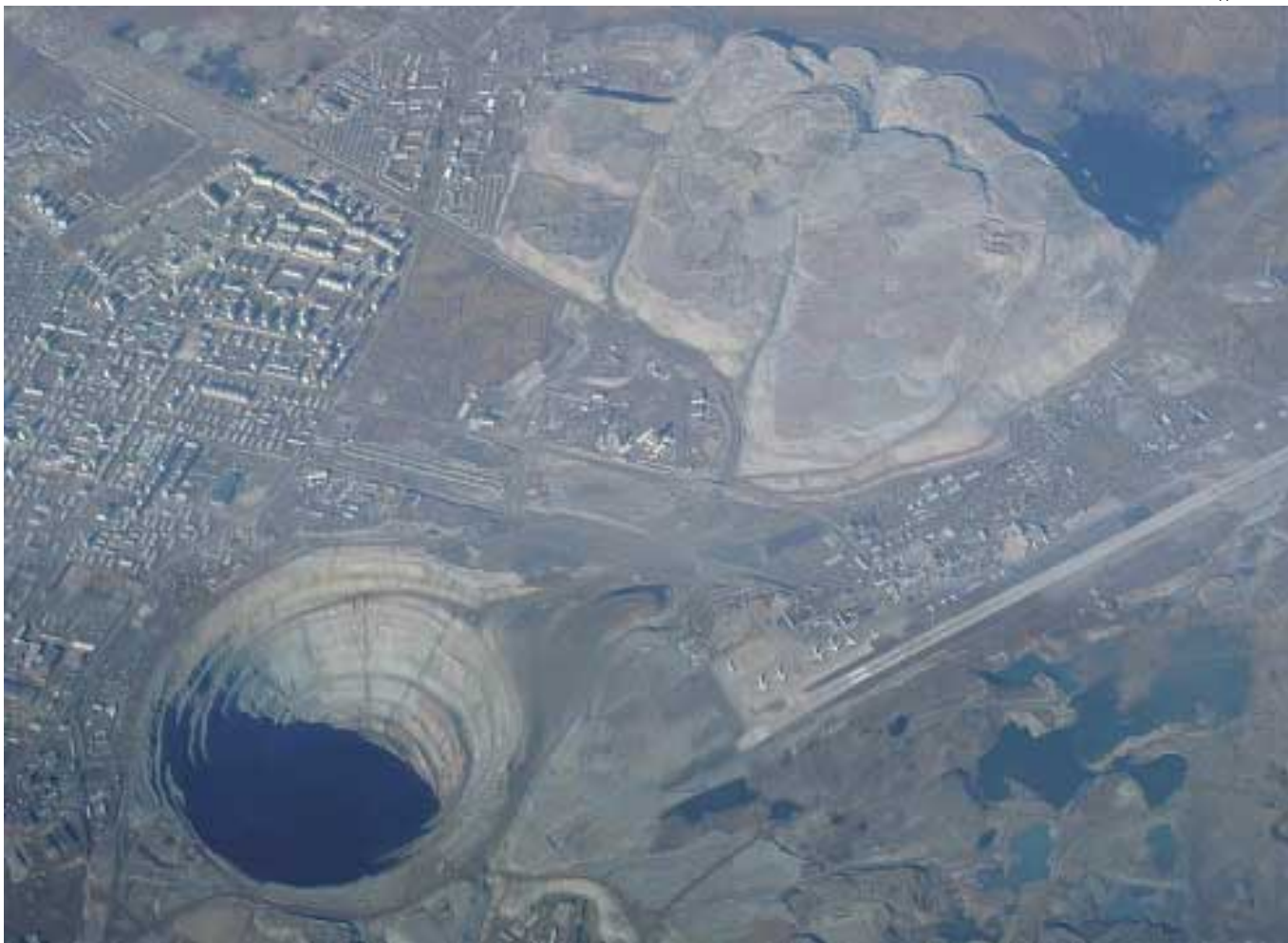
Глубочайший в России карьер «Мир» диаметром 1200 м и глубиной 525 м. Добыча алмазоносной кимберлитовой руды прекращена на нем в июне 2001 г. С высоты видно, что площадь отвалов более чем в 2 раза превышает площадь самого карьера. В настоящее время на борту карьера ведется строительство подземного рудника для отработки оставшихся запасов, выемка которых открытым способом нерентабельна. Республика Саха (Якутия)
