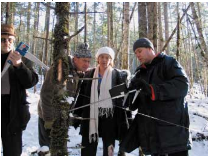
Рис. 4. Использование электронной мерной вилки при отводе лесосек
