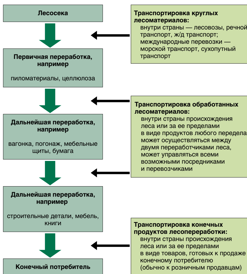
Рис. 1. Типичная схема движения лесоматериалов от лесосеки до конечного потребителя. Слева представлены стадии переработки древесного сырья, справа — описание способов передвижения сырья по цепи переработки
