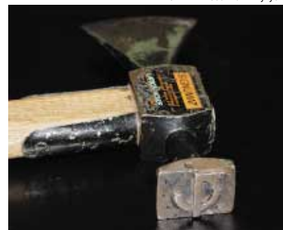
Рис. 11. Применение ударных клейм для маркировки древесины в компании «Тернейлес»
