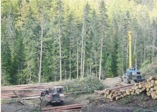
Самоходная канатная установка OWREN (Советское лесничество Хабаровского края)
