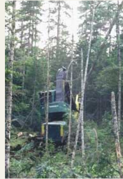
Чересполосные постепенные рубки, выполняемые с использованием валочно-пакетирующей машины «Тимберджек-2618» с выравниваемой верхней конструкцией (Таежное участковое лесничество Приморского края)
